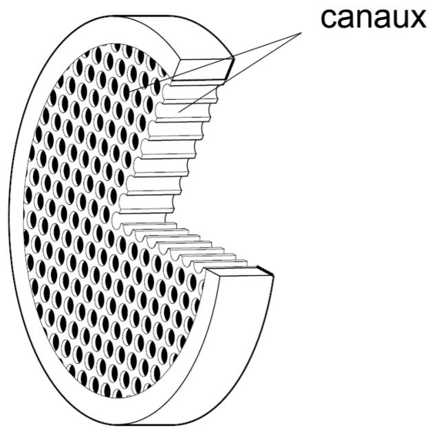
Shéma de la structure d'une MCP
